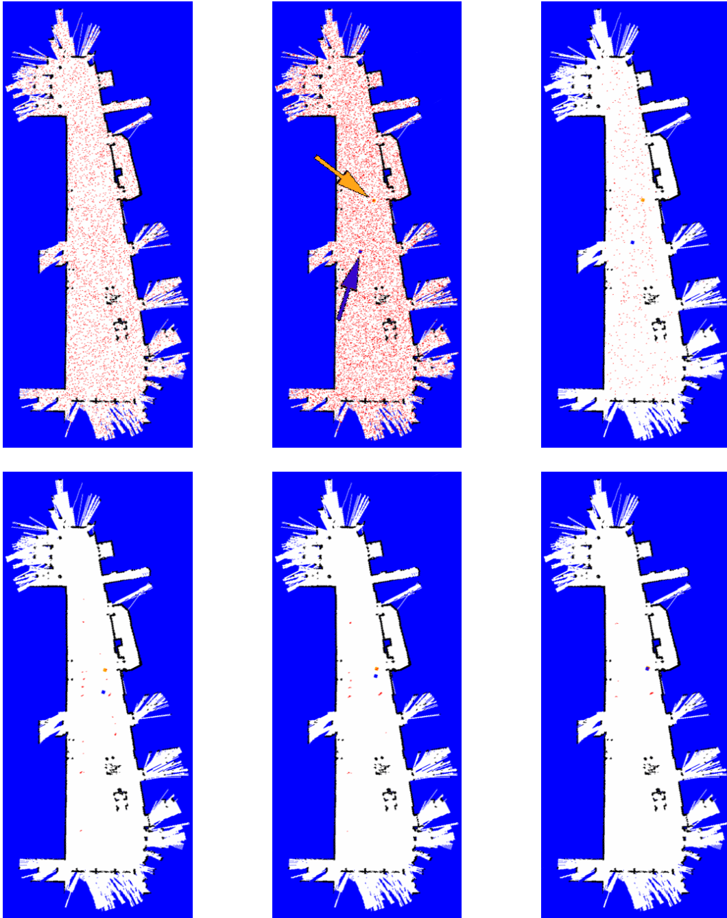
Abbildung 6.5.: Gezeigt werden die ersten sechs Resampling-Schritte einer globalen Lokalisierung im Gebäude 101 mit KLD-Sampling. Die anfängliche Samplezahl wurde auf 5000 gesetzt. Diese Samplezahl wird zunächst erhöht, da die gewünschte Approximationsgüte nicht gewährleistet werden kann (oberste Zeile, mittleres Bild). Die gelbe Markierung zeigt die tatsächliche Position des Roboters, die blaue Markierung die lokalisierte Position. Die Samples werden durch die roten Punkte dargestellt.
